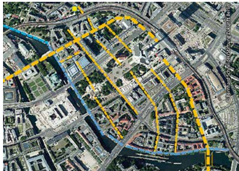
Projektion historischer topografischer Beziehungen auf den heutigen Stadtgrundriss östlich des Humboldt Forums. Einschließlich des Spreeuferers (blau) sichern sechs Querbeziehungen die Verknüpfung des Großraums zwischen Humboldt Forum und Fernsehturm mit den angrenzenden Quartieren, um ein zusammenhängendes System öffentlicher Räume wiederherzustellen. Der gelbe Punkt markiert den Hackeschen Markt, die äußere Kurve den Altstadtring.
